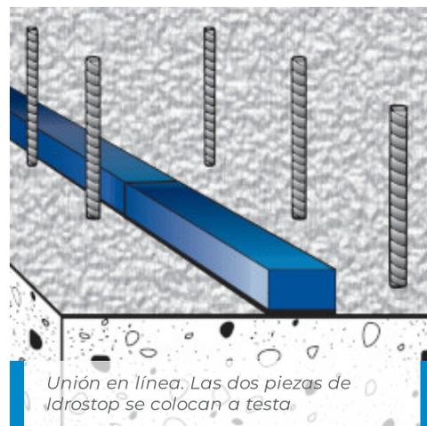
Unión en línea. Las dos piezas de Idrostop se colocan a testa.
