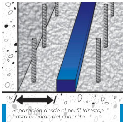
Separación desde el perfil Idrostop hasta el borde del concreto
