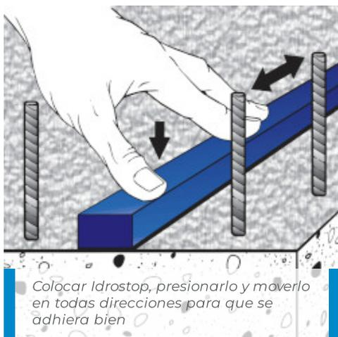
Colocar Idrostop, presionarlo y moverlo en todas direcciones para que se adhiera bien
