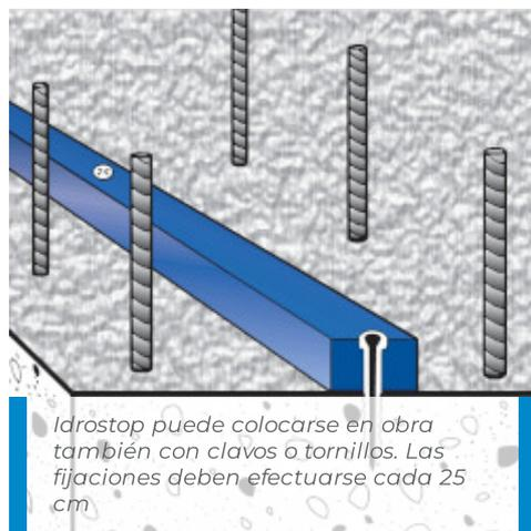
Idrostop puede colocarse en obra también con clavos o tornillos. Las fijaciones deben efectuarse cada 25 cm
