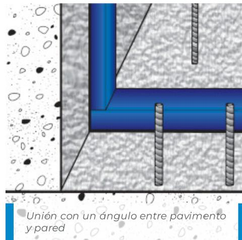
Unión con un ángulo entre pavimento y pared
